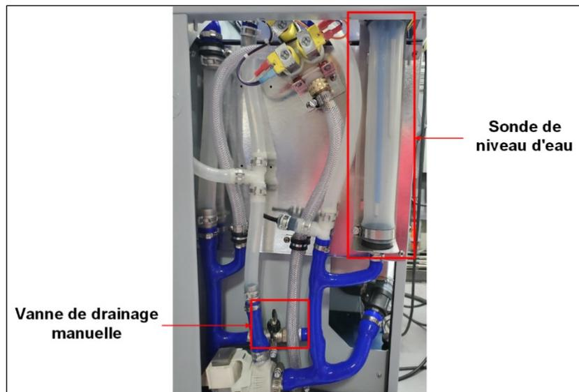
**Étape 3.** La sonde de niveau d'eau va ensuite commencer à se remplir jusqu'à temps que le niveau atteigne le capteur résistif inférieur. L'opération de remplissage automatique peut être arrêter à n'importe quel moment en appuyant et maintenant sur Enter ✓ pendant 3 secondes.
